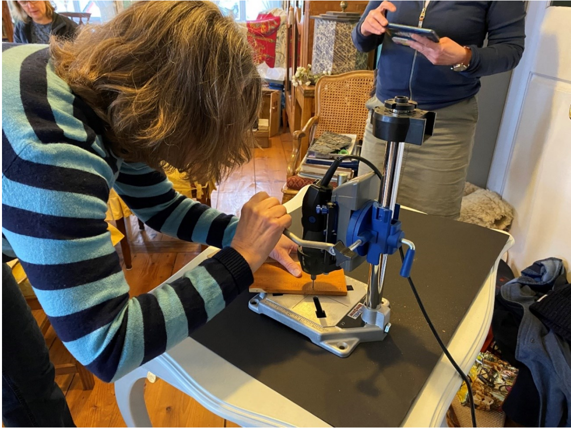
Bild 9: Das Bohren von Löchern mit einem Dremel (elektrischer Handbohrer) in einem Tischständer © L. Bahr 2023
