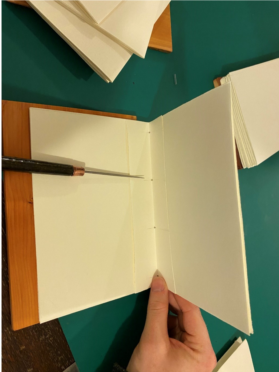
Bild 5: Eine Lage, eine Schablone und eine Ahle zum Durchstechen! © L. Bahr 2023
