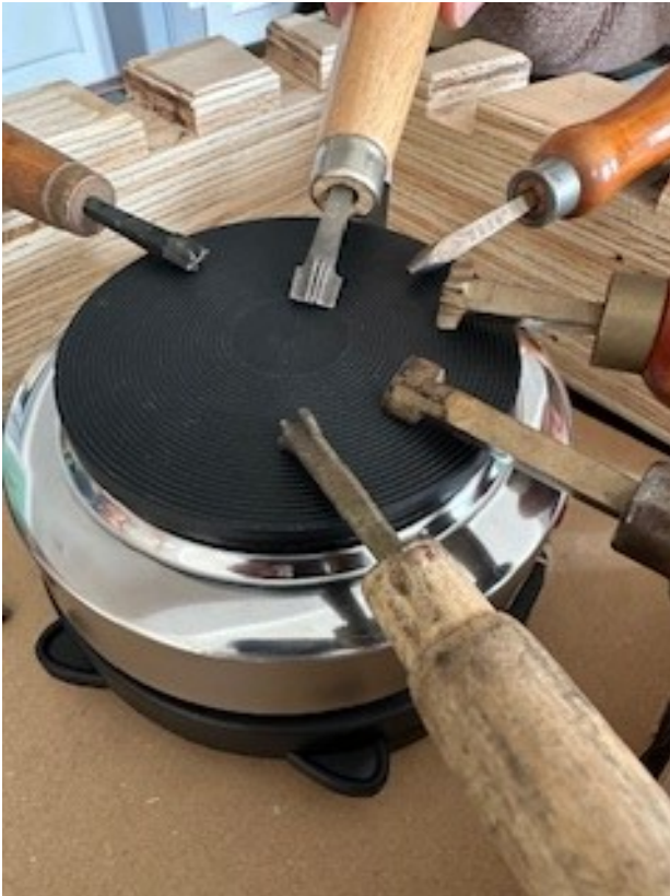
Die Werkzeuge für die Einbandprägung Foto: V. Böll, 2025
