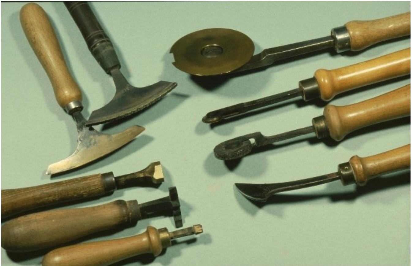
Vergoldewerkzeuge: Fileten, Stempel, Rollen und Streicheisen
